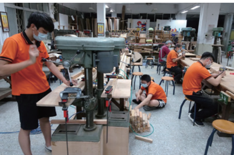
在大安高工木工老師引導下，志工運用臺灣杉進行原木標註、裁切、引孔等。
